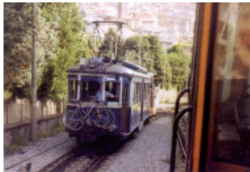
All’inizio della ripida salita, a Piazza Scorcola, la carrozza tramviaria viene agganciata in coda a un **carro scudo** (un piccolo locomotore “funicolare” collegato a una robusta fune metallica) che la
